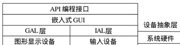
图 1 一种可移植嵌入式 GUI 的实现结构
